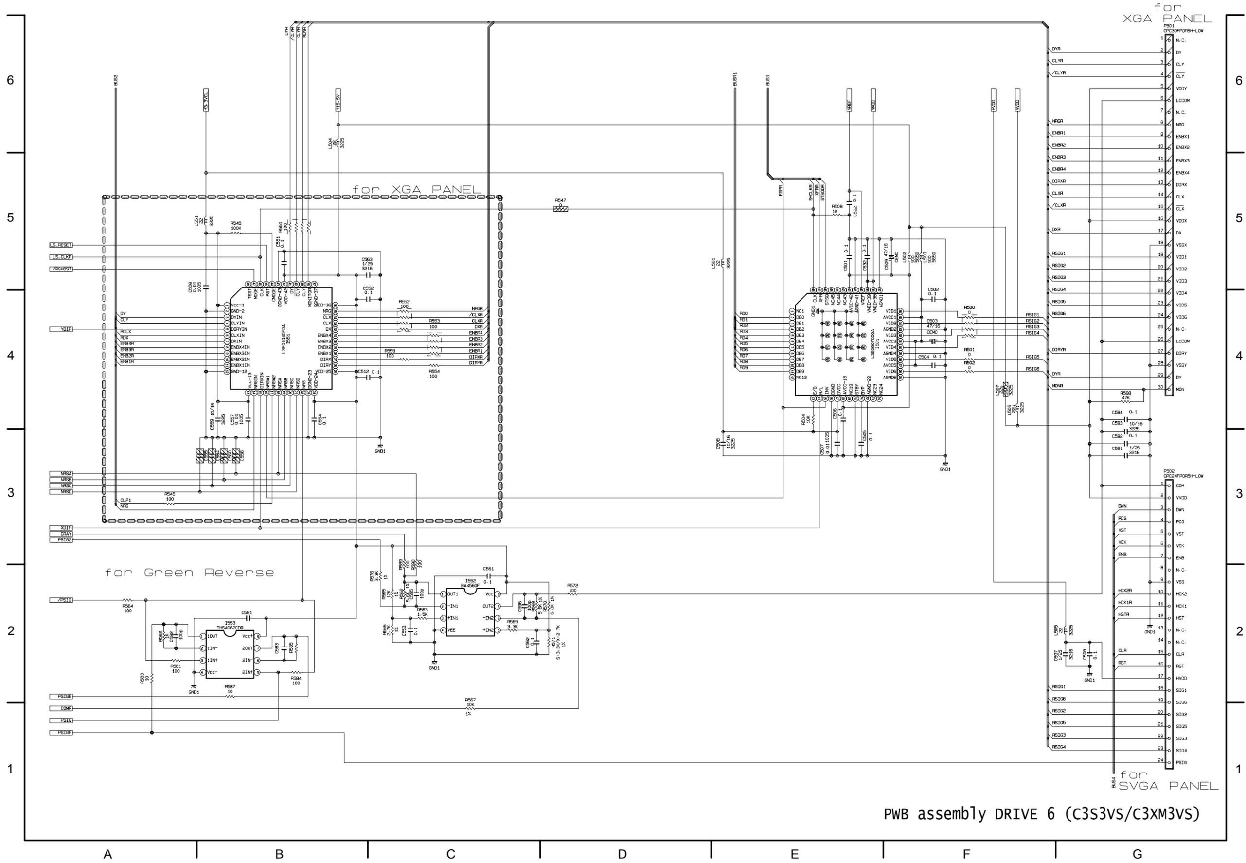
PWB assembly DRIVE 6 (C3S3VS/C3XM3VS)
