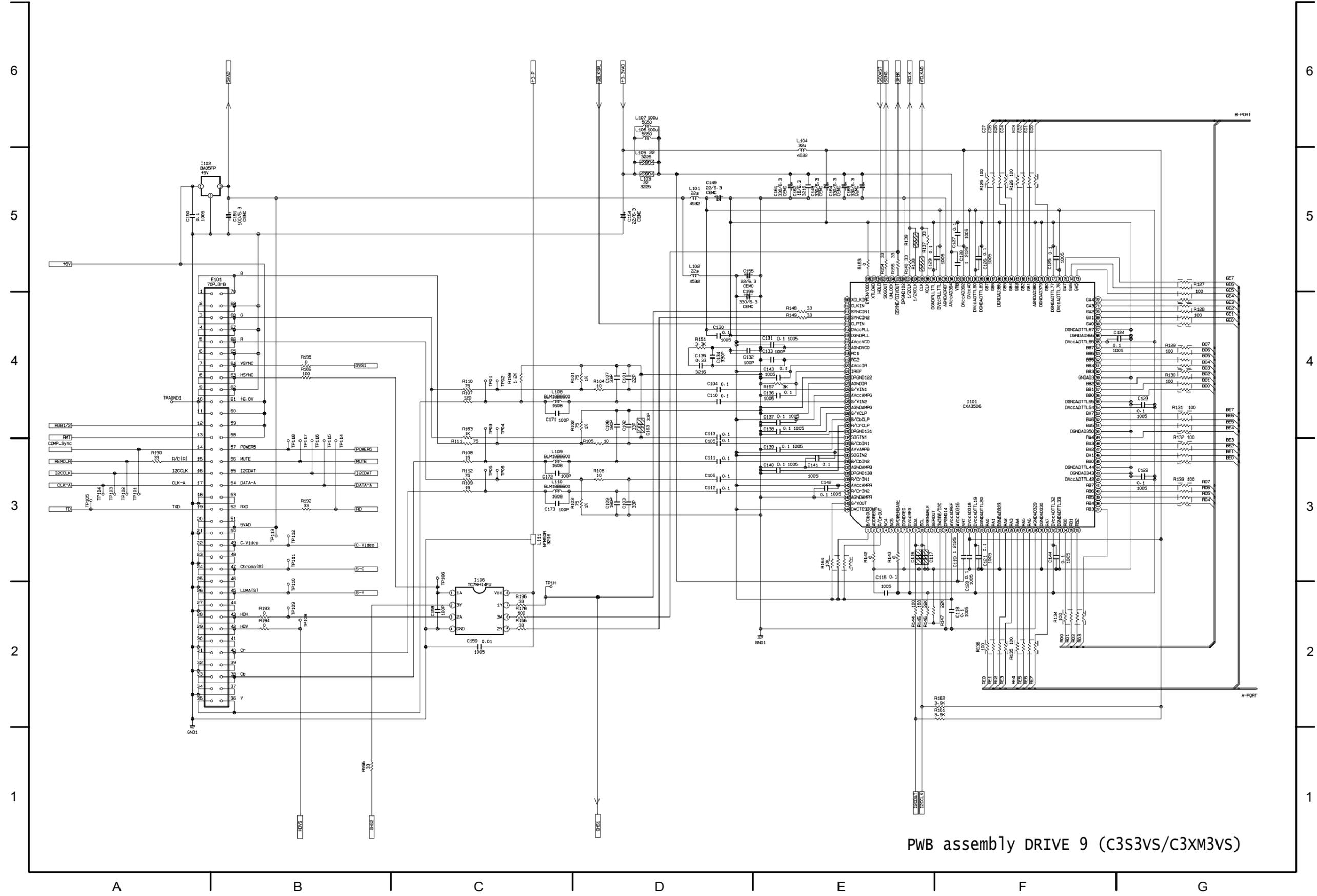
PWB assembly DRIVE 9 (C3S3VS/C3XM3VS)
